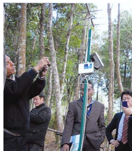
アンテナとソーラー電源
