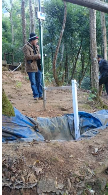
早期警報デモンストレーション施設 左：水位計、 右：警報装置
