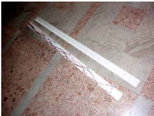
箱型水位計完成
