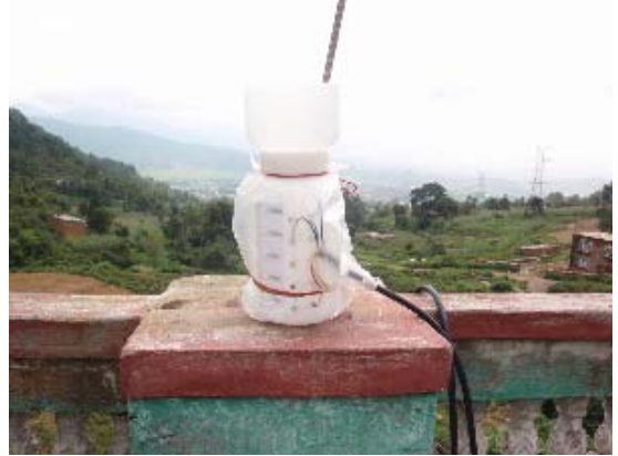
雨量計側接続完了
