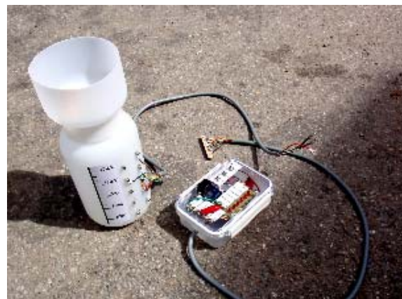
完成した雨量監視警報装置
