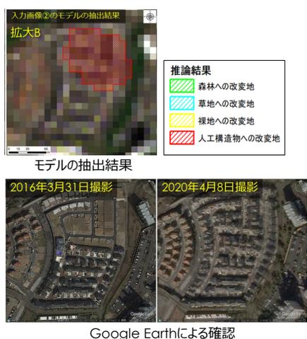
図 3 セマンティック・セグメンテーション手法による抽出結果と GoogleEarth の航空写真等によるアノテーションクラス別の分類精度の検証の例(郊外の住宅地)
