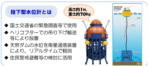
図1 投下型水位計の概要 [株式会社拓和ホームページの画像をもとに作成]
