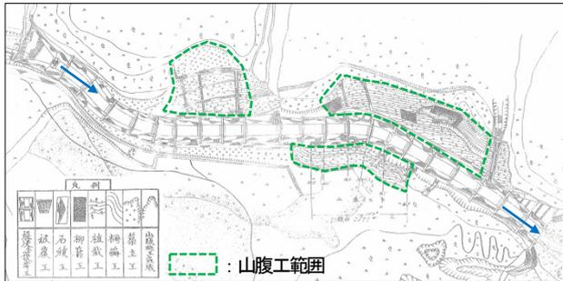
図1 泥谷砂防堰堤群の山腹工の位置図
