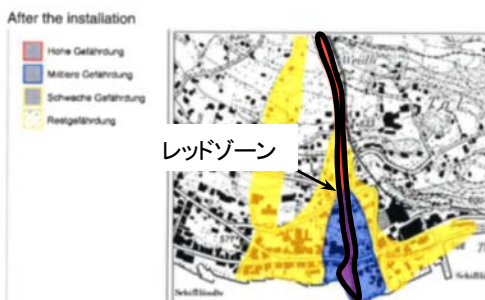
図2 トラクト川の施設設置位置(上図)及びハザードマップ(災害発生後:中図、施設設置後:下図)
