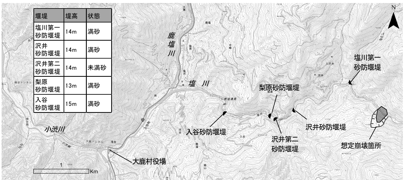
図 2 塩川流域平面図と堰堤諸元（地理院地図 http://maps.gsi.go.jp/ に加筆）
