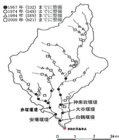
図-4 住吉川流域の砂防堰堤位置
