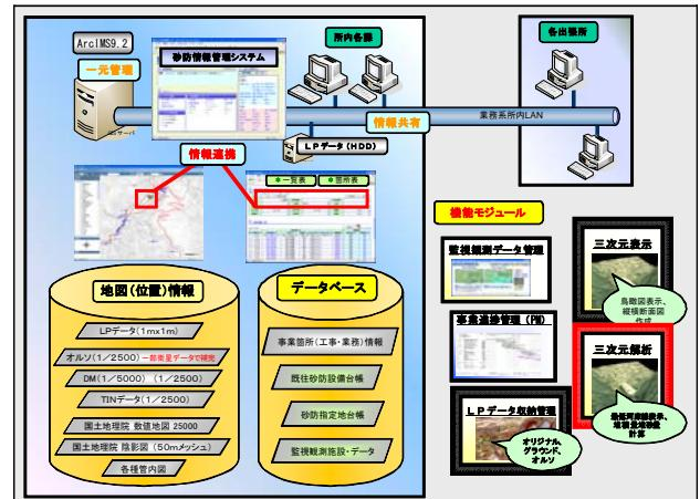
図-2 砂防関連情報管理システム概略図
