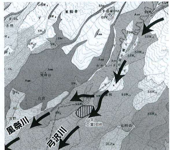
図-5 溶岩流の分布とスラッシュ雪崩が風祭川方向に分流した地点（津屋、1968 に加筆）
