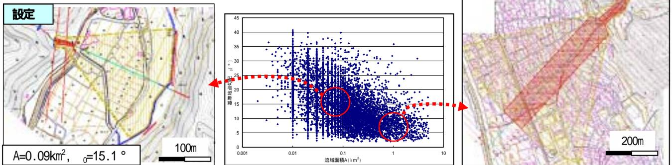
図 2.10 流域面積と基準地点勾配の関係からみた土石流の区域設定事例
