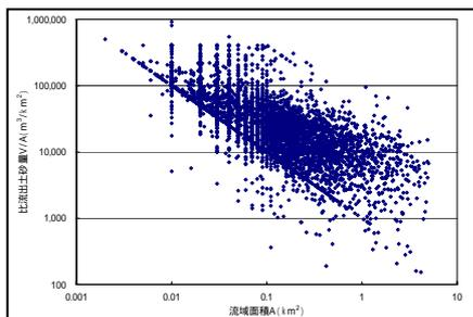
図 2.5 流域面積と比流出土砂量
