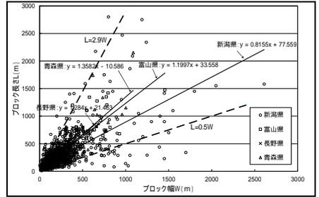
図 2.9 地滑りブロックの幅と長さ
