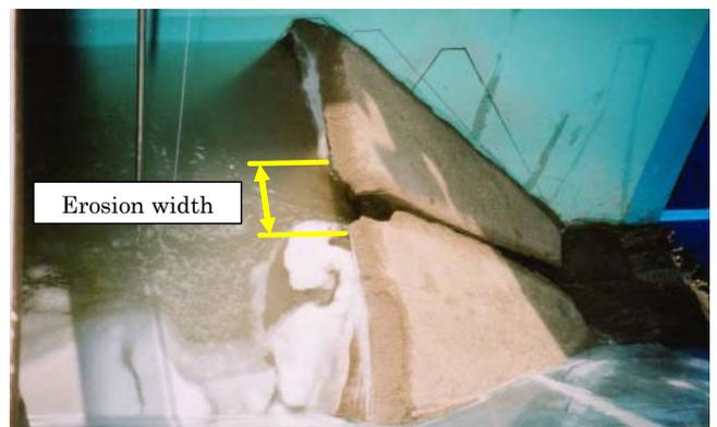
写真-1 ピーク流量時の侵食状況と侵食幅 (No.5, 越流開始から 27 秒後)
