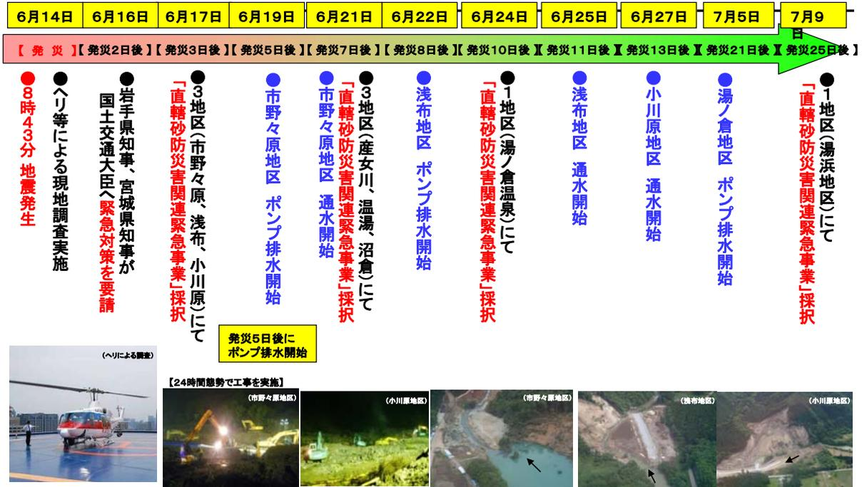
図 4.5 岩手・宮城内陸地震時の大規模土砂災害（天然ダム）対応の流れ
