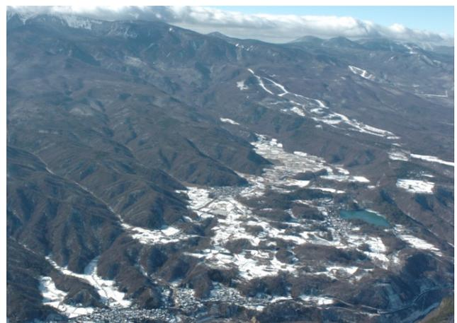
写真 2.2 北八ヶ岳の山体崩壊と岩屑なだれ堆積物(防災科学技術研究所 井口隆 2002 年 12 月 22 日撮影)
