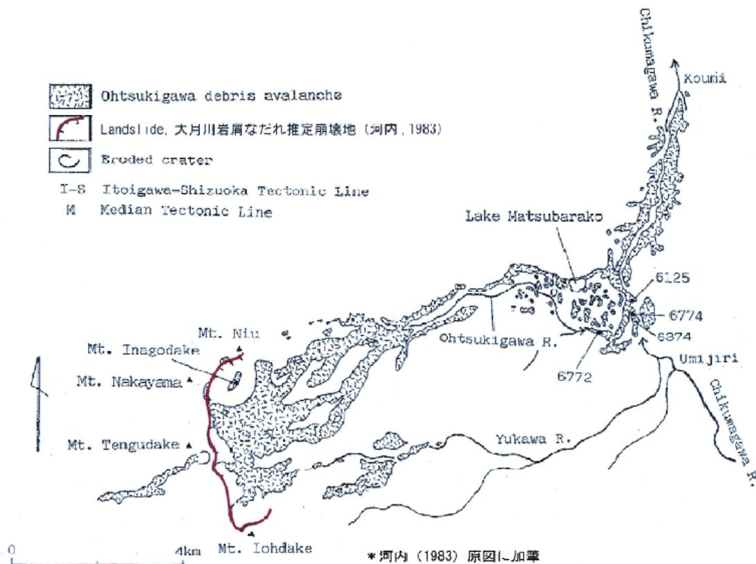
図 2.3 八ヶ岳の山体崩壊と大月川岩屑なだれの堆積範囲
