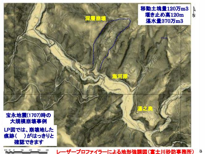
図 2.17 レーザープロファイラーによる天然ダム地点の地形強調図 (富士川砂防事務所 2010 作成)
