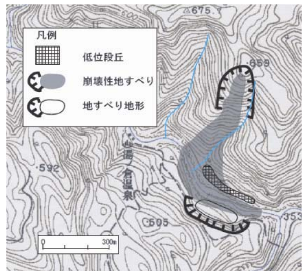
図 1.23 湯ノ倉地区の崩壊性地すべりによる河道閉塞（基図は国土地理院 1/2.5 万数値地図「切留」）
