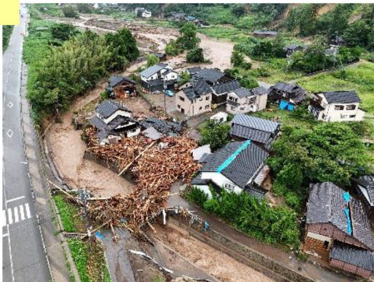
横断工作物(橋)に大量の流木が捕捉
