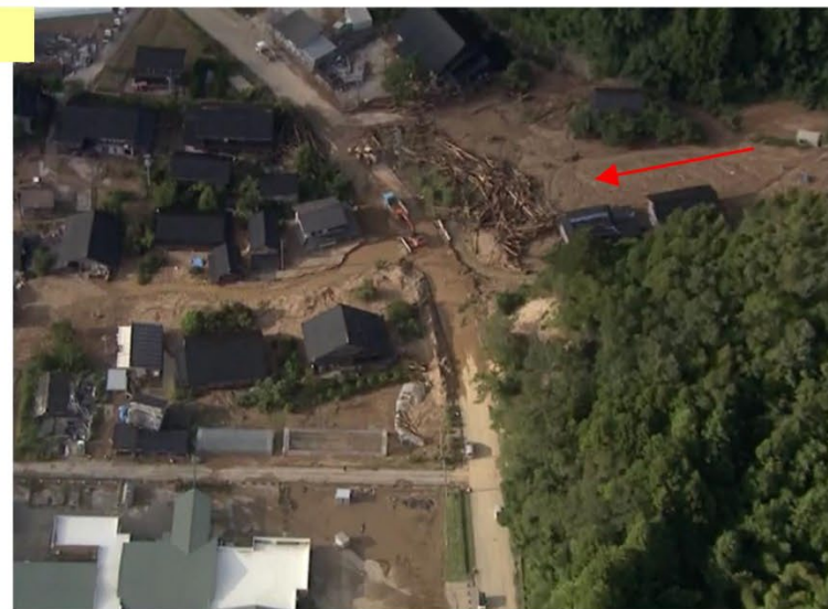
土砂、流木が流出して横断工作物(橋)を閉塞、氾濫が拡大
