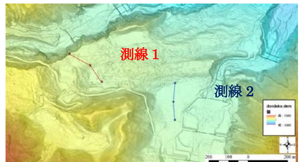
図1 電気探査測線位置
